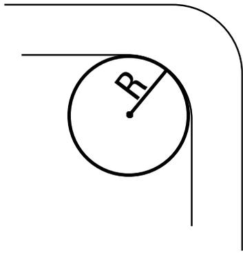
曲げ半径は、曲げの「内側」で測定します。
